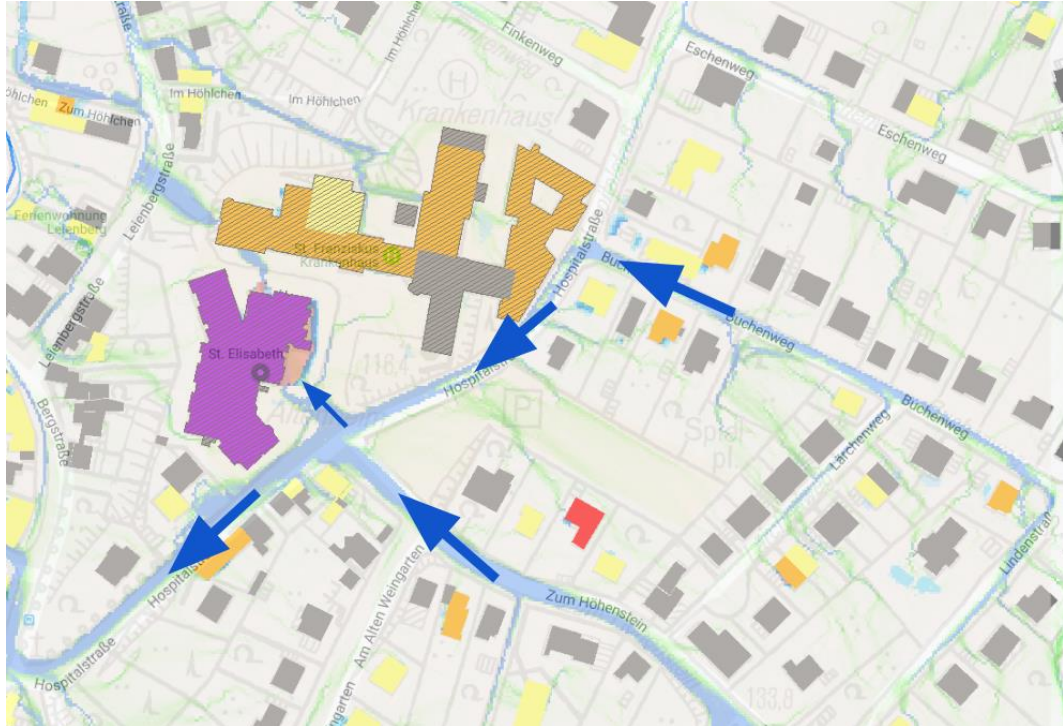
Abbildung 5.3: Hauptfließwege am Eitorfer Krankenhaus (Detail)
